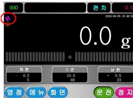
④ 운전상태에서 피계량물이 계량부를 통과하는 동안 중량을 측정하고 그 결과를 중량으로 표시합니다. 표시된 중량은 다음 피계량물이 진입할 때까지 유지되며 약30초 동안 진입이 없을 경우 측정 결과치는 초기화 됩니다. 측정된 피계량물의 중량 등급이 화면 하단에 하한, 기준, 상한으로 표시되며 이에 연동하여 선별기의 선별동작으로 피계량물이 분류 됩니다.
