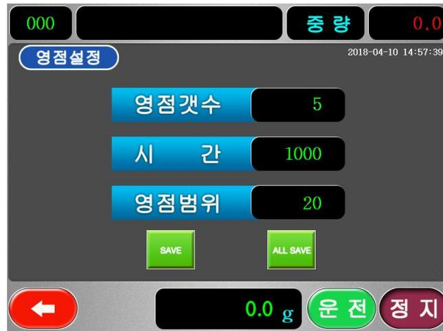
영점 자동 보정기능(Auto Zero Tracking)을 위한 설정입니다. 온도의 변화 및 이물질의 누적등 외부적 요인에 의해 영점이 서서히 변하게 됩니다. 이 변화를 중량선별기가 인지하여 자동으로 보정하는 기능입니다.
