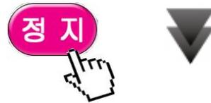
⑤ 작업이 종료되어 컨베이어를 멈추고자 할 경우 정지키를 누릅니다. 화면은 정지화면으로 전환되고 컨베이어가 정지합니다. 이 상태에서는 진입센서를 통과하여도 계수 및 판정을 하지 않으며 일반 저울처럼 중량을 표시합니다.
